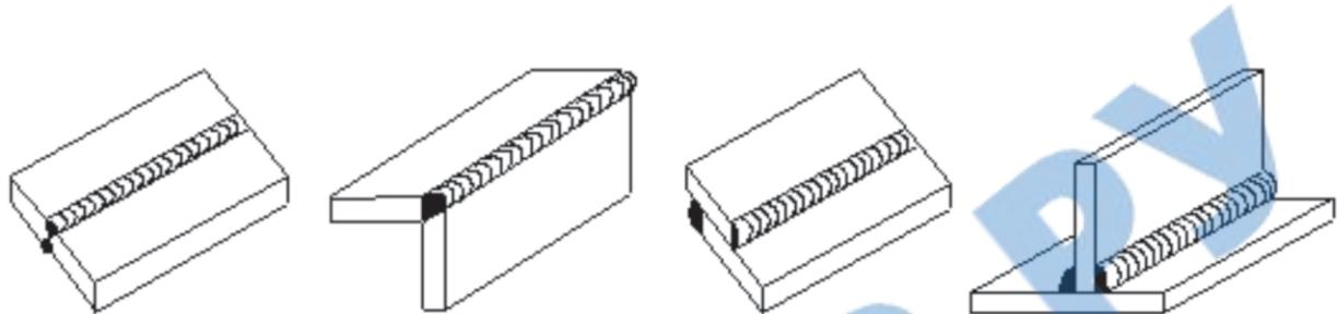
Стыковое соединение Угловое соединение Нахлесточное соединение Т-образное соединение
