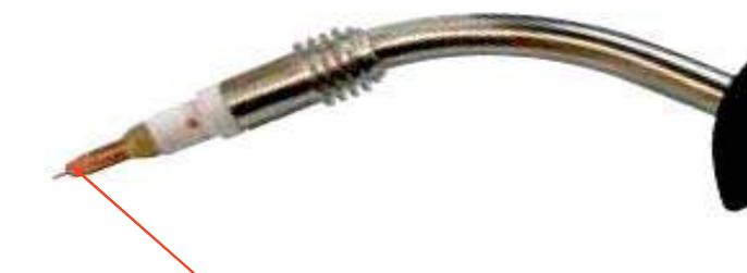
(11) Установите контактный наконечник соответствующего размера, пропустив проволоку через него, зафиксируйте контактный наконечник.
