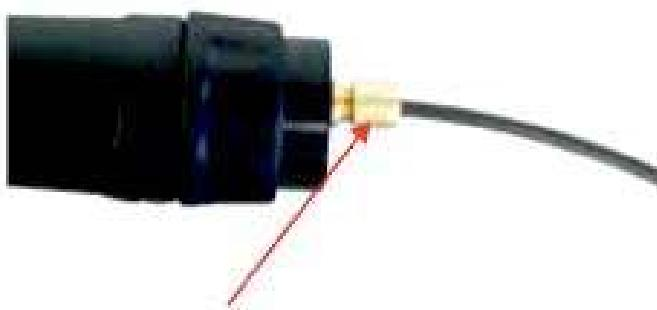
(6) Пропустите канал в провод горелки и затяните затяжную гайку.
