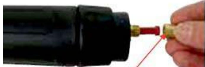
(2) Снимите затяжную гайку канала с евроразъема горелки.
