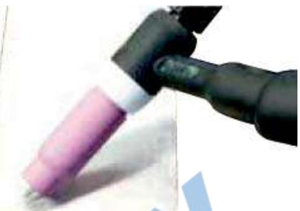
(13) Положите край сопла на рабочую деталь, при этом вольфрамовый электрод должен находиться в 1-2мм от рабочей детали. Нажмите и удерживайте переключатель горелки, газ начнёт поступать.
