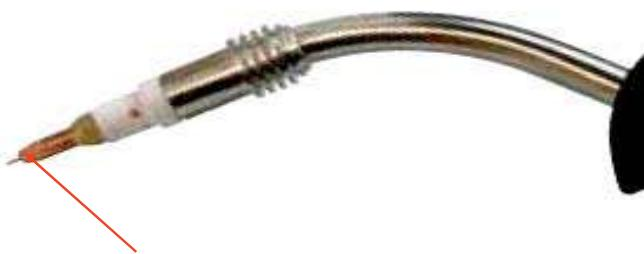
(11) Установите контактный наконечник соответствующего размера, пропустив проволоку через него, зафиксируйте контактный наконечник.
