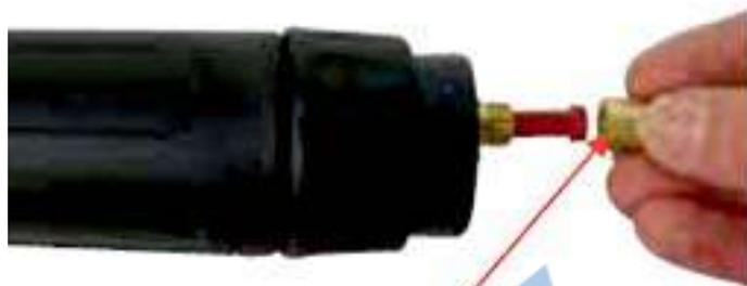
(2) Снимите затяжную гайку канала с евроразъема горелки.
