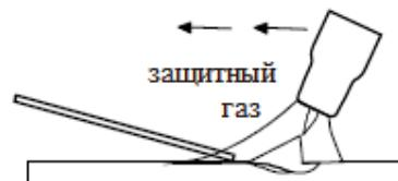
Перемещение горелки вперёд к передней части сварочной ванны
