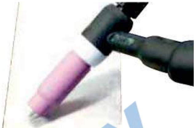
(13) Положите край сопла на рабочую деталь, при этом вольфрамовый электрод должен находиться в 1-2мм от рабочей детали. Нажмите и удерживайте переключатель горелки, газ начнёт поступать.
