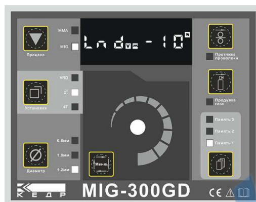
Изображение 9 : Успешно отрегулированный дисплей предварительной настройки диапазона индуктивности при MIG сварке
