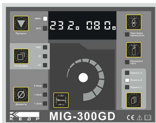
Изображение 4: Показатели дисплея при режиме сварки MMA
