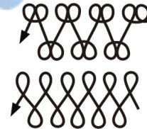
Используют для усиленного прогревания кромок шва, особенно при сварке высоколегированных сталей. Электрод задерживаются на краях, чтобы не было прожога в центре шва или вытекания металла при сварке вертикальных швов.
