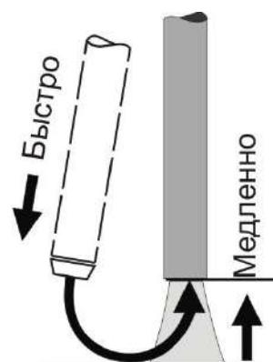
**Положения электрода при сварке**
