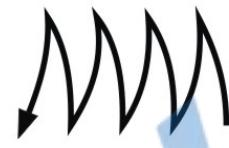
Используют для сварки в нижнем положении, а также для вертикальных и потолочных швов с выпуклой наружной поверхностью.
