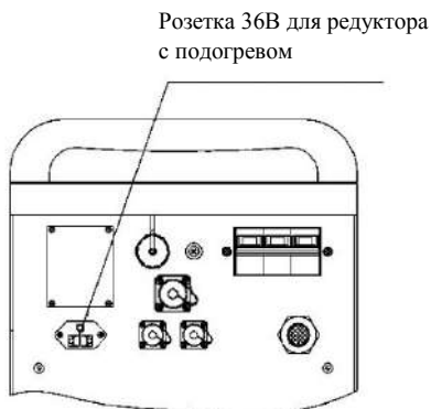
Рис. 6.16. Задняя панель источника питания (верхняя часть). Разъемы могут отличаться.
