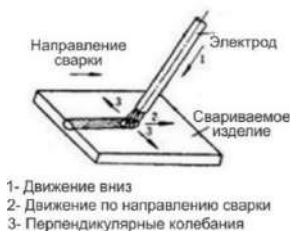
Рисунок 13.4 Три основных направления движения электрода
