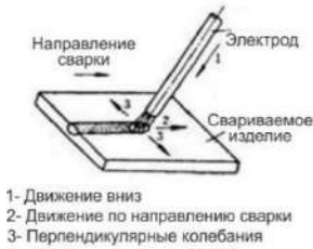
Рисунок 13.4 Три основных направления движения электрода
