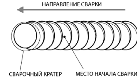
Рис. 11.6. Начало сварки при смене электрода.
